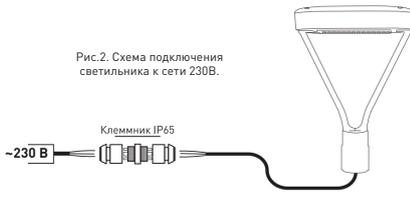
Рис.1. 230В шамчыракты токто туташтыруу схемасы
