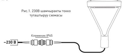
3.3.4. После проверки правильности подключения можно включать сетевое напряжение.
