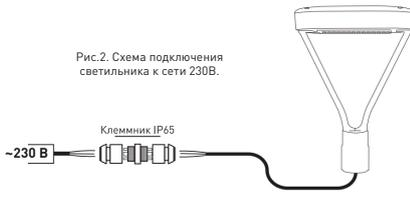
Рис.1. 230В шамчыракты токто туташтыруу схемасы
