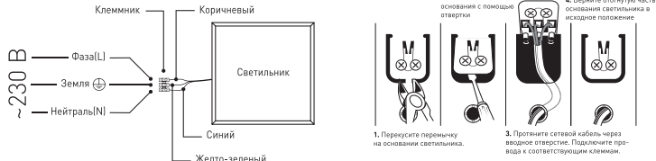
Рис.1. Схема подключения светильника SPO-6-36...-А (с клеммником для БАТ). Рис.2. Схема подключения светильника SPO-6-36 (без клеммника для БАТ) к сети 230В.
