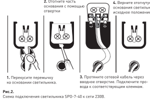
Рис.2. Схема подключения светильника SPO-7-40 к сети 230В.
